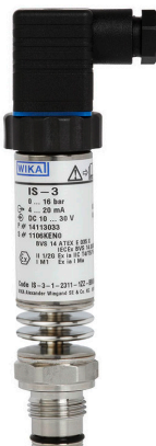
IS-3 special +150°C med utvändig membran med inbyggt kylelement temperaturområde -40+150°C
