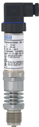
IS-3 special +150°C med utvändig gänga med inbyggt kylelement temperaturområde -40+150°C
